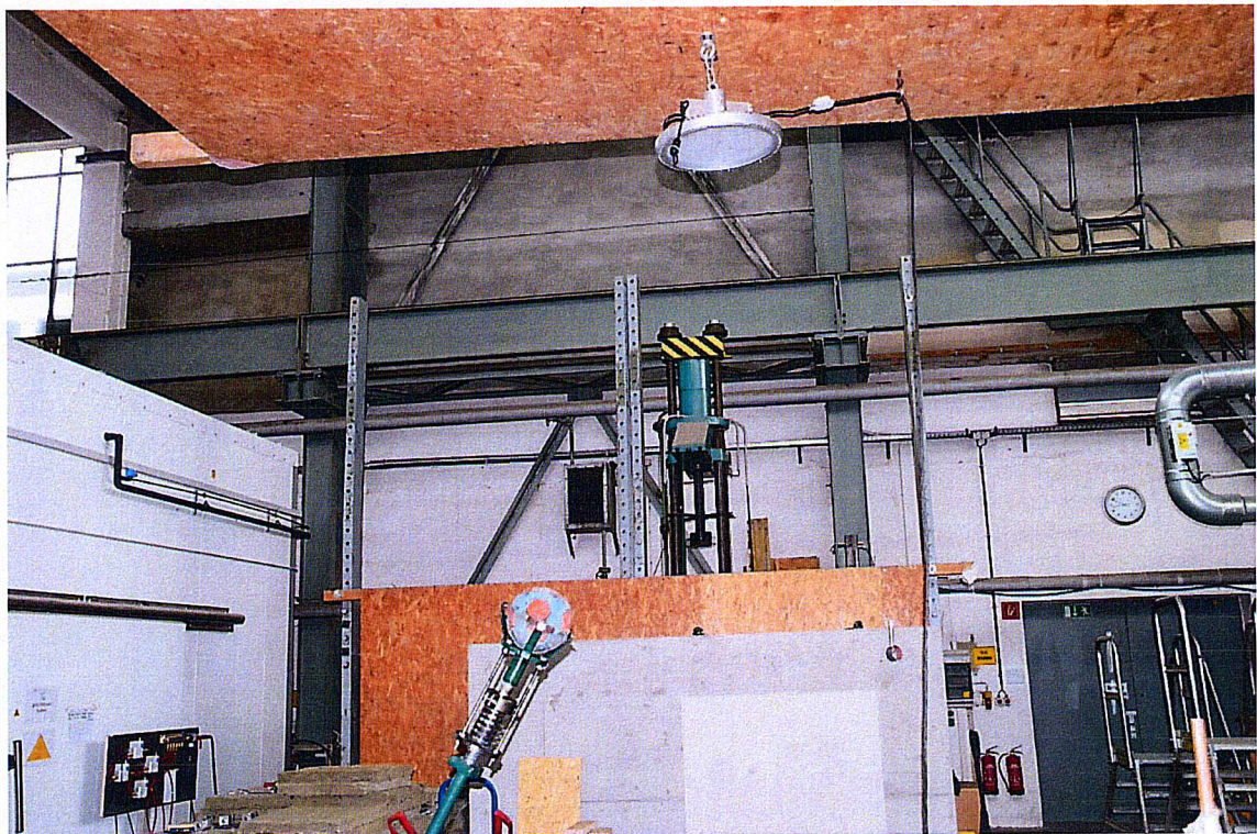
Abbildung A1-2: Versuchsaufbau, Auftreffwinkel 60°
