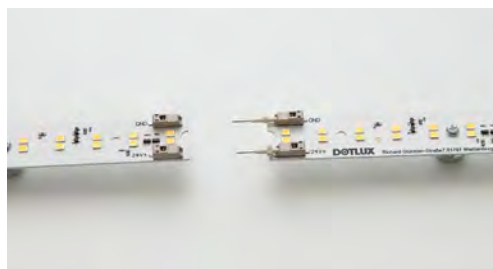
Les luminaires LED peuvent être connectés en ligne à l'aide de connecteurs à broches (outil d'extraction inclus).
